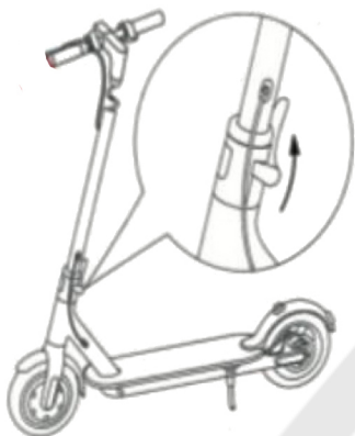
Pas 1 - Securizați coloana centrală prin siguranța mecanismului de pliere /depliere
